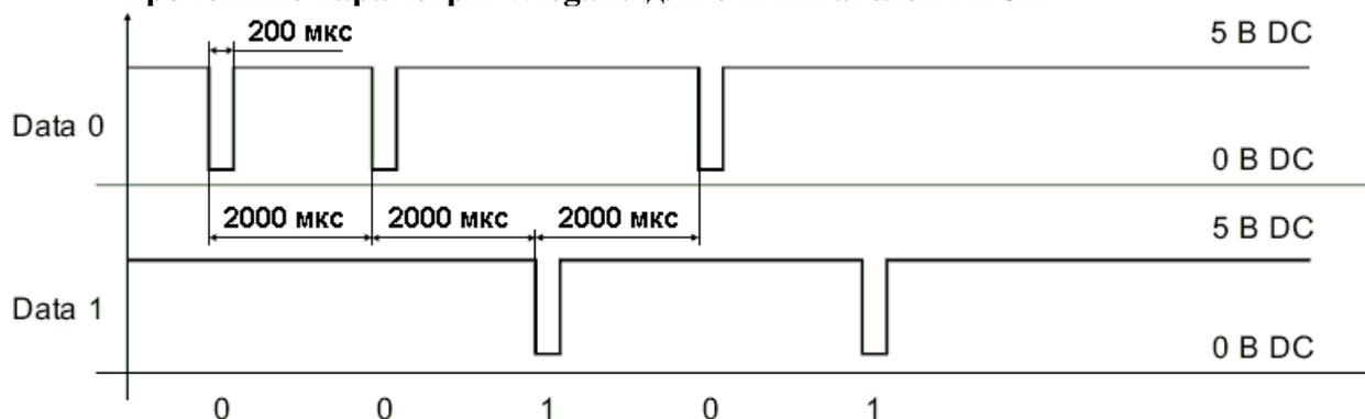
Наличие импульса в линии “DATA\_0” означает, что был передан 0, наличие импульса в линии “DATA\_1” означает, что была передана 1.
