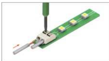
Кабель с многопроводной жилой вставляется после нажатия на фиксатор клеммы.
