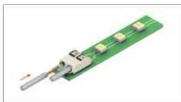
Кабель с однопроводной жилой вставляется без инструмента.
